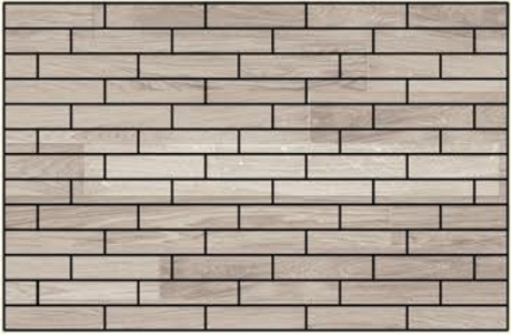
pianta: schema di posa pavimento in gres effetto legno formato 15x60 o 20x120 cm
